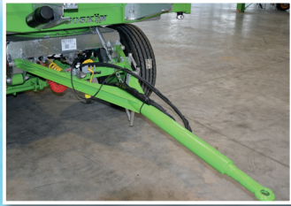
Y-Deichsel für einfaches Manövrieren
