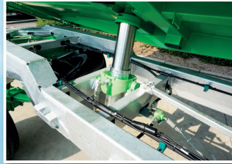
Verzinktes und tiefliegendes Fahrgestell
