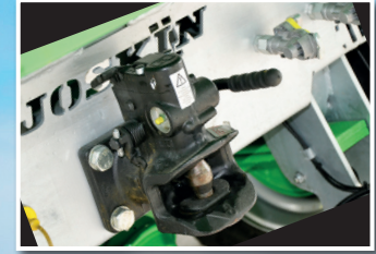
Hinteres automatisches Zugmaul mit Vollausrüstung
